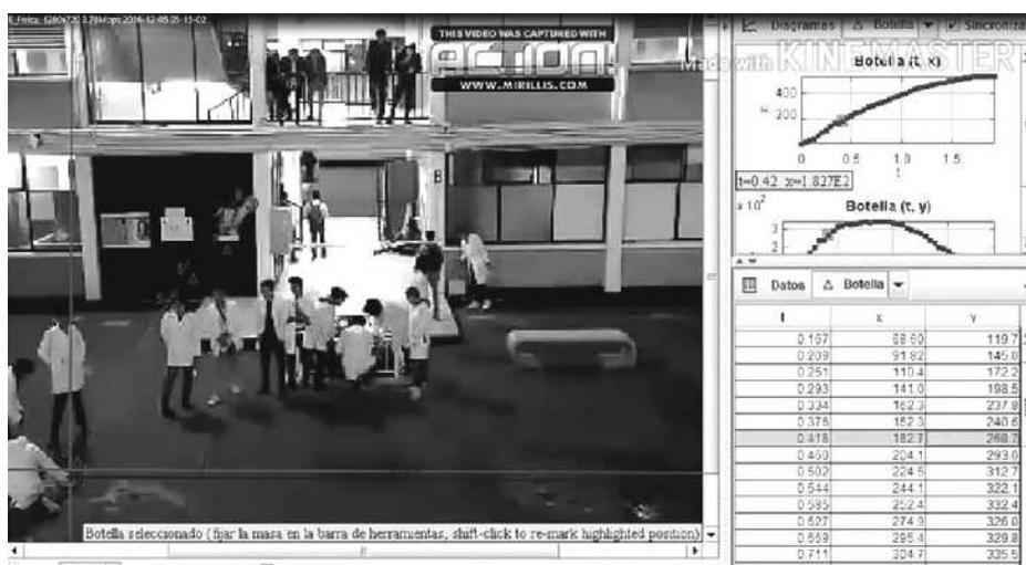
**Figura 3.** Primer lanzamiento del cohete hidráulico Botella a ¼ litro de capacidad de agua Fuente: Elaboración propia
