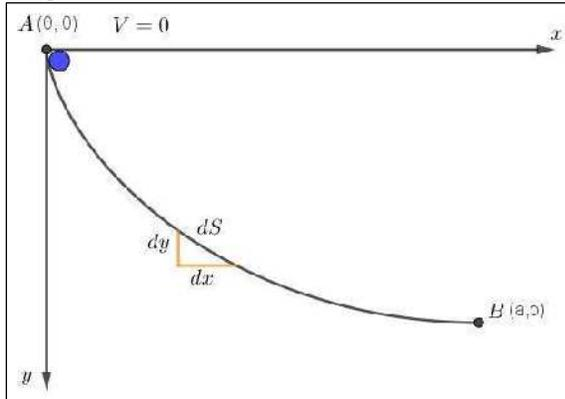
Figura 6. Media cicloide invertida con sus diferenciales
