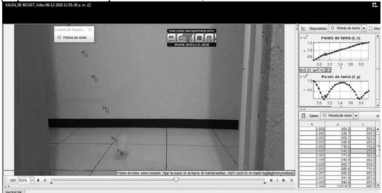
**Figura 2. Trayectoria del lanzamiento de la pelota de tenis, analizado con Tracker**
