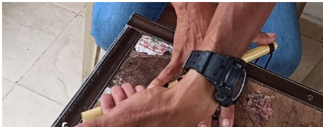
Figura 1. El artesano haciendo uso de la cuarta y los dedos para medir la longitud de una flauta de millo.
