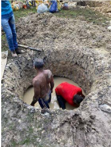
Figura 4: Buraco para a extração da argila.
