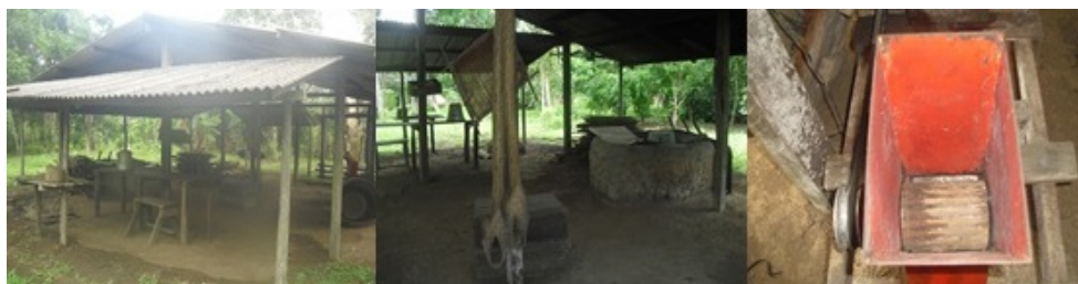
Figura 1. a) Casa de farinha, b) Tipiti e forno, c) Catitu. Fonte: Acervo Fotográfico dos pesquisadores.
